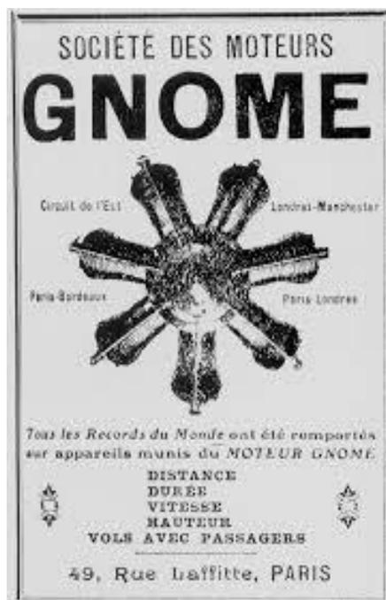
Le prototype du premier moteur rotatif qui sort des ateliers de Genevilliers en 1908, est baptisé Omega, il se caractérise par la rotation des cylindres et du bloc moteur autour du vilebrequin qui est fixé et doit être boulonné à un support.
